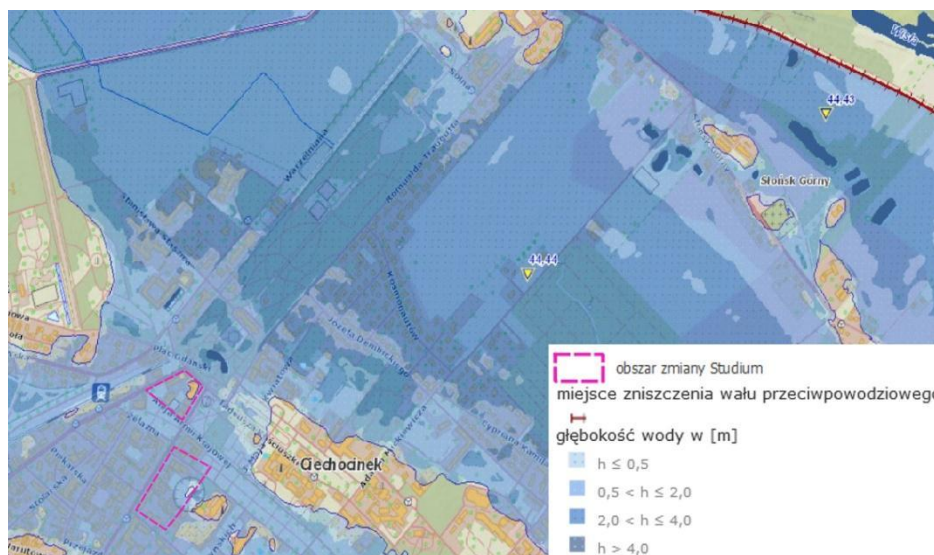
Rysunek 15. Narażenie obszaru zmiany Studium na zalanie w przypadku zniszczenia lub uszkodzenia wałów przeciwpowodziowych (źródło: Mapy zagrożenia powodziowego; Mapy ryzyka powodziowego (Arkusz N-34-110- B- c-1) opublikowane na stronie http://mapy.isok.gov.pl ; dostęp 18.02.2021 r.)
