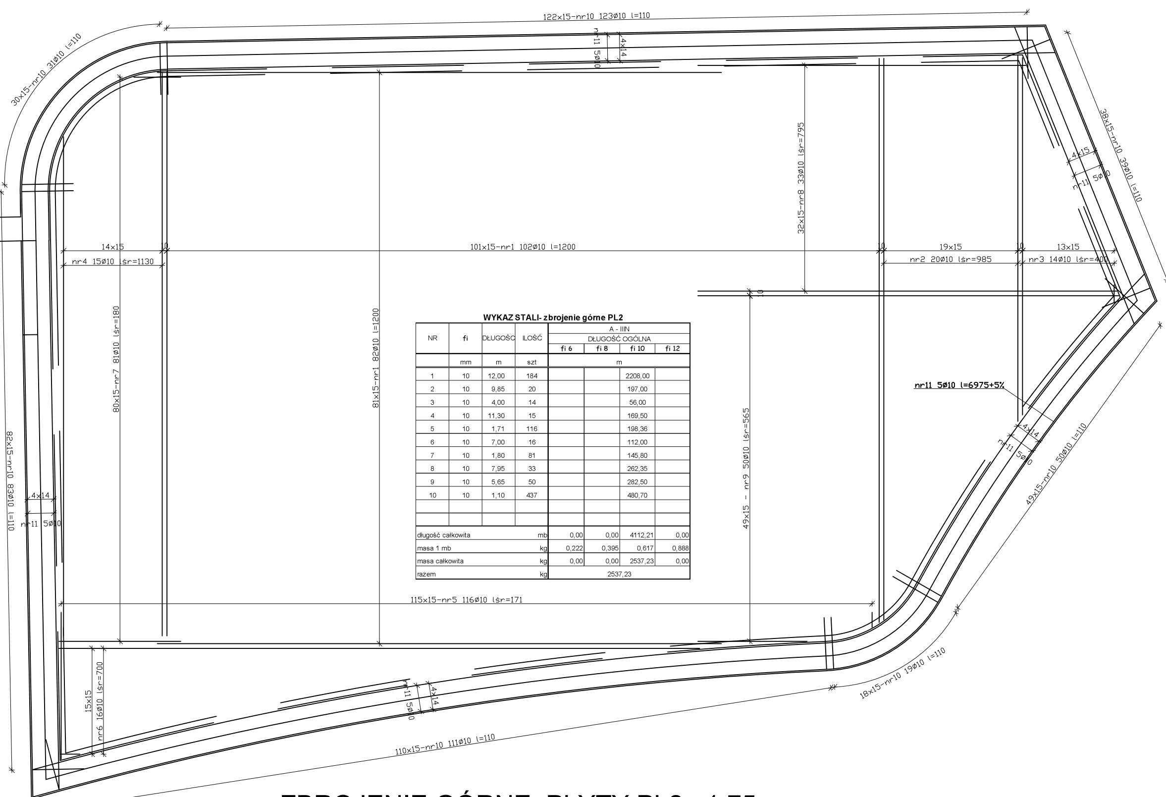
ZBROJENIE GÓRNE PŁYTY PL2 1:75
